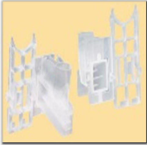
รูปที่ 3 อุปกรณ์ประกอบ (Chamber megafunnel) สำหรับใช้กับเครื่อง Cyto-spin Chamber megafunnel ใหม่ (ซ้ายมือ) Chamber megafunnel ใช้ซ้ำ (ขวามือ)
