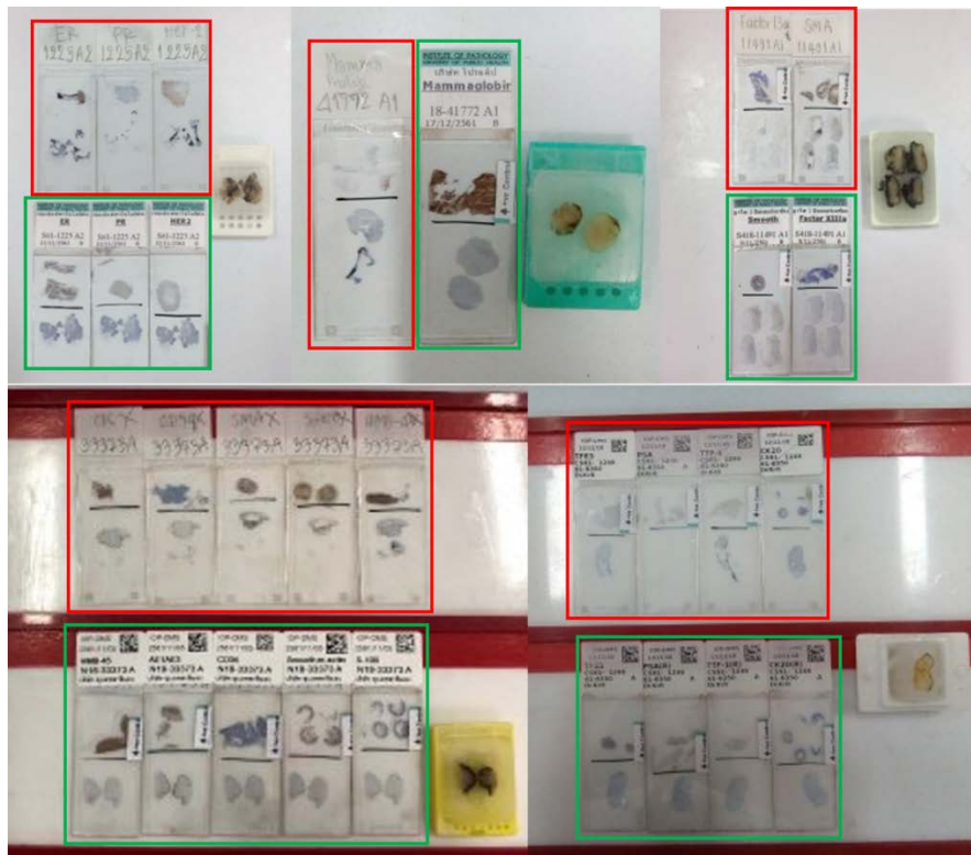
ภาพที่ 1 เปรียบเทียบสไลด์แก้วประจุบวกหลังการย้อมกับพาราฟินบล็อก สไลด์แก้วประจุบวกไม่ได้เคลือบ Egg Albumin (กรอบสีแดง) และสไลด์แก้วประจุบวกเคลือบ Egg Albumin (กรอบสีเขียว)
